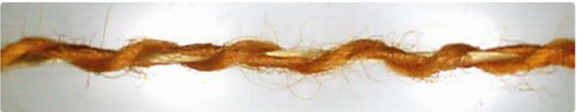
Рисунок 3.1 – Фотографии наработанных образцов неоднородных нитей с различным числом обкручиваний (КР 14,3 + 2ПА 29,4)
