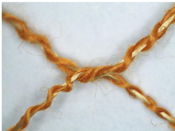
Рисунок 3.12 – Внешний вид комбинированной нити до проведения испытания
