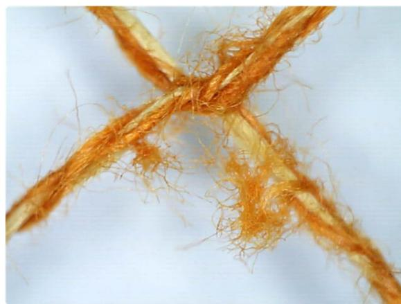
Рисунок 3.13 – Внешний вид комбинированной нити после 400 циклов истирания
