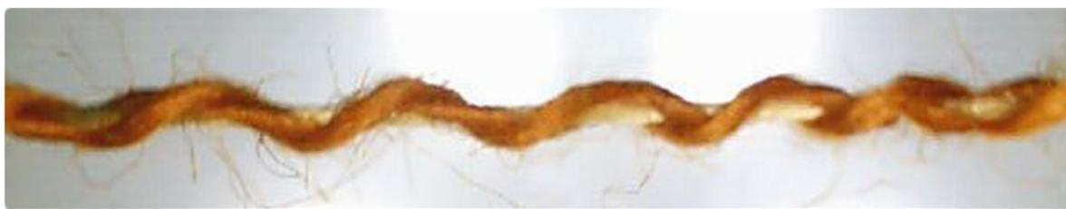
Рисунок 3.2 – Фотографии наработанных образцов неоднородных нитей с различным числом обкручиваний (КР 29,4 + 2ПА 29,4)
