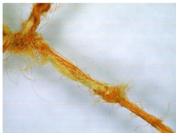
Рисунок 3.15 – Внешний вид комбинированной нити после 3000 циклов истирания
