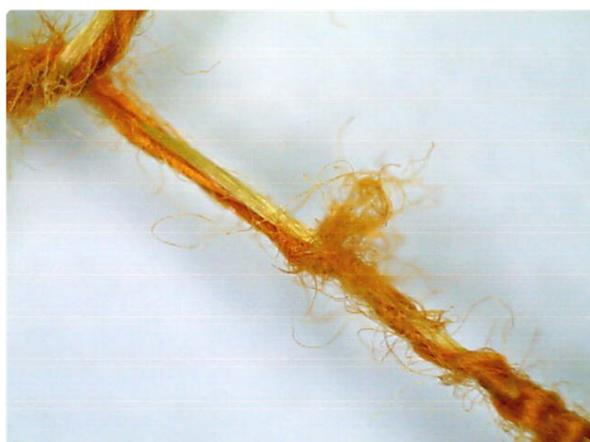
Рисунок 3.14 – Внешний вид комбинированной нити после 1200 циклов истирания
